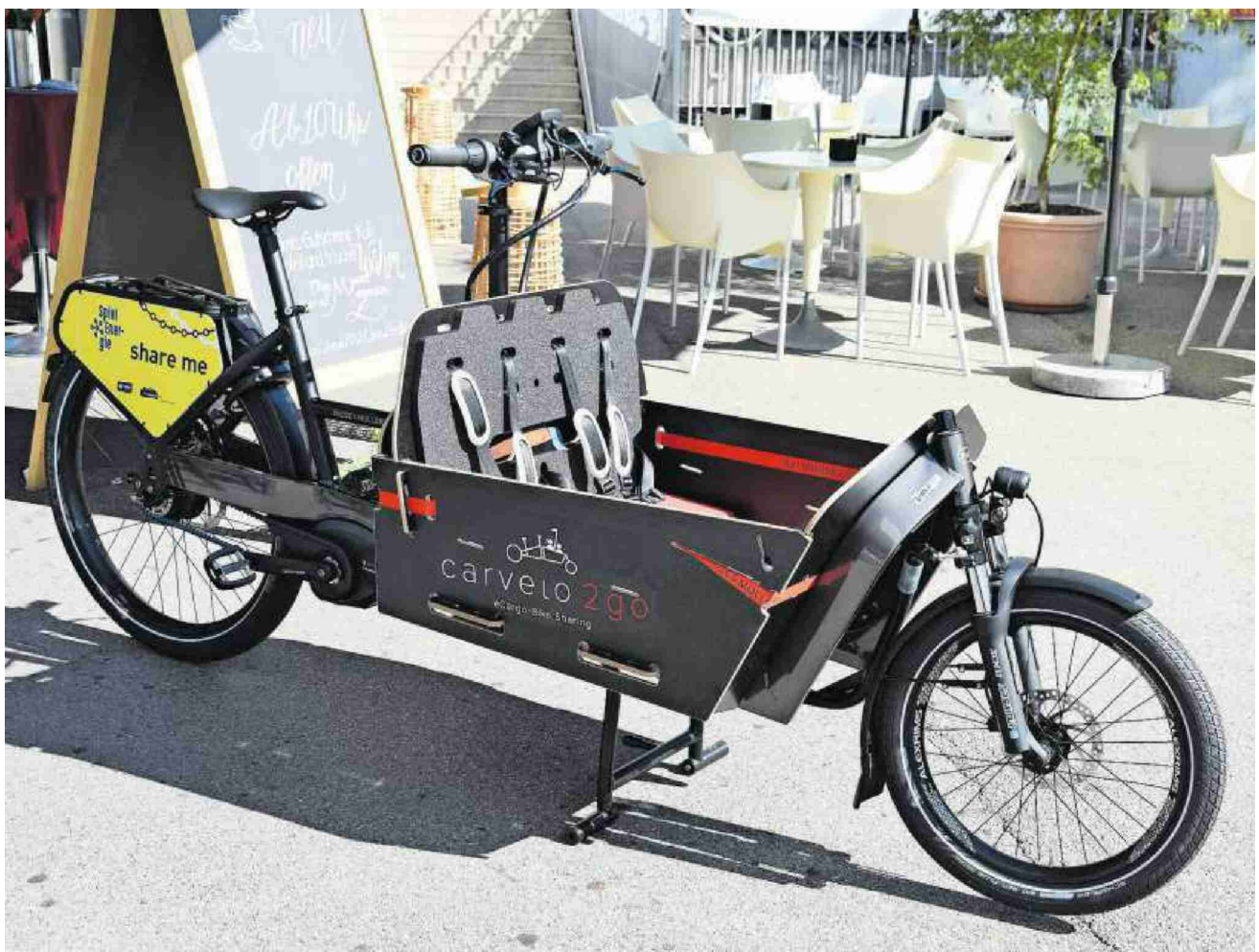
Das Cargo-Bike ist ein spezielles Velo: Zwischen Lenkrad und Vorderrad befindet sich ein Laderaum.
